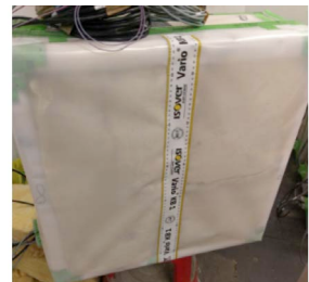
Vastgeniet dampscherm met tape
