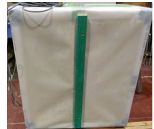
Vastgeniet dampscherm met houten stijl (ideaal geval)
