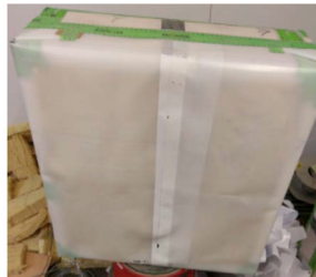
Overlappend dampscherm met dubbelzijdige tape
