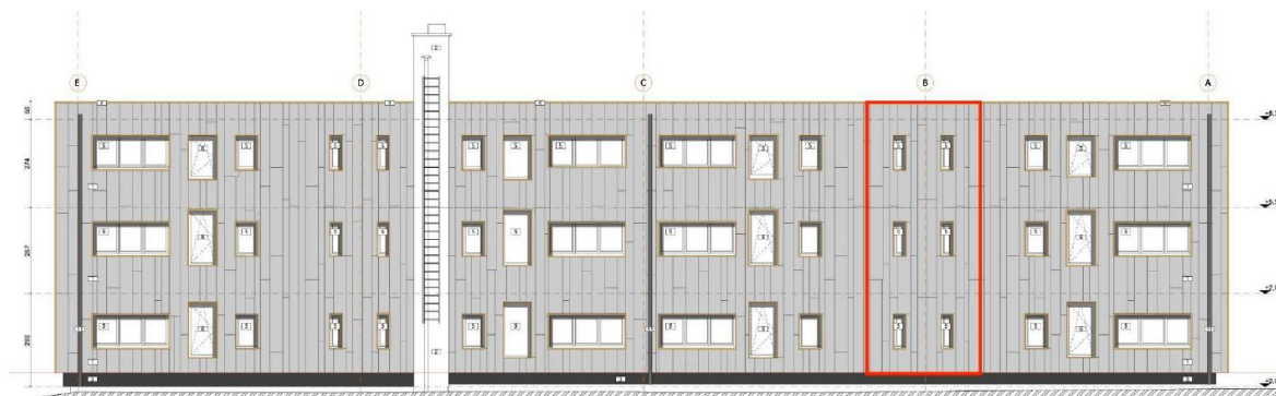
Afbeelding 6. Aanzicht van de achtergevel voor de prototyping
