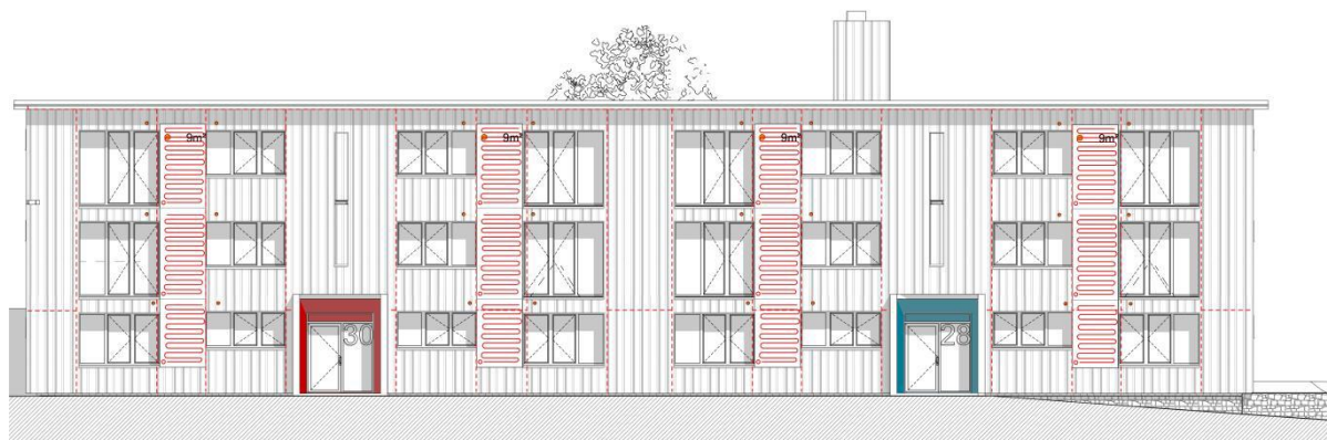
Afbeelding 6. Trombewanden voor luchtverwarming
