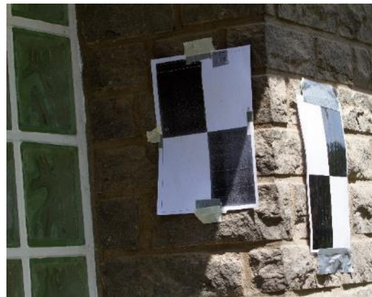
Afbeelding 7. Targets aan de buitenkant van het gebouw voor uitlijning van de puntenwolken
