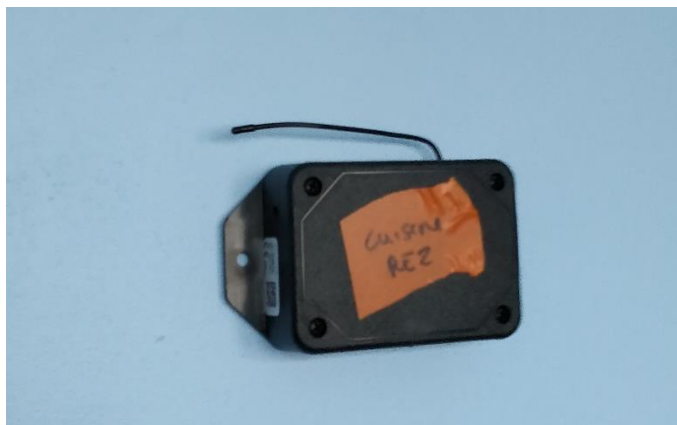
Afbeelding 13. Voorbeeld van een draadloze sensor die gebruikt werd tijdens de monitoringcampagne
