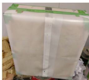
Pare-vapeur superposé avec tape double-face
