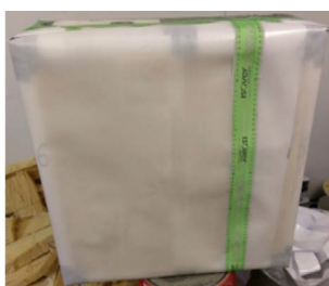
Pare-vapeur superposé avec tape sans aide du montant central
