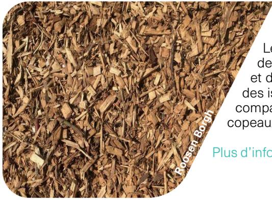
Les copeaux de bois sont des sous-produits de scierie, auxquels on peut ajouter des additifs pour augmenter certaines propriétés. Matériau disponible localement et donc très peu onéreux, il peut être mis en œuvre par **épandage** en vrac pour des isolations de combles. L'isolation en vrac permet un remplissage complet des compartiments dans les endroits difficilement accessibles. L'épandage en vrac des copeaux de bois n'est pas soumis à des règles professionnelles.
