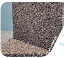
Les panneaux de chanvre sont fabriqués à partir de fibres de chènevotte et de liant minéral (principalement de la chaux). Ils sont employés pour leurs performances thermiques et de régulation hygroscopique. Parfaitement adaptés pour la rénovation d'anciens bâtiments, ils peuvent être utilisés en complément d'isolation intérieure ou en cloisons. Ils servent de base pour les enduits ouverts à la vapeur et se posent similairement à des panneaux de plâtres ou d'OSB.
