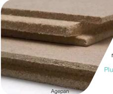
Les panneaux sont formés par pressage de fibres de bois et de bitume ou de paraffine. En sous-toiture, ils protègent des ruissellements ponctuels. Dans le cas d'un bardage ajouré, ils nécessiteront toutefois l'ajout d'une membrane pare-pluie. Ils ne peuvent pas être considérés comme éléments structurels. Ils ont une bonne résistance à l'eau et l'humidité.
