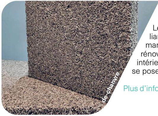
Les panneaux de chanvre sont fabriqués à partir de fibres de chènevotte et de liant minéral (principalement de la chaux). Ils sont employés pour leurs performances thermiques et de régulation hygrosopique. Parfaitement adaptés pour la rénovation d'anciens bâtiments, ils peuvent être utilisés en complément d'isolation intérieure ou en cloisons. Ils servent de base pour les enduits ouverts à la vapeur et se posent similairement à des panneaux de plâtres ou d'OSB.
