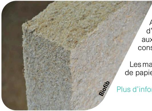
Aussi appelés isolants souples, les matelas en cellulose et chanvre servent d'isolation entre ossatures dans de multiples applications. Ils s'adaptent bien aux irrégularités et peuvent être utilisés aussi bien en rénovation que pour les constructions neuves. Ils se posent simplement comme les autres laines du marché.
